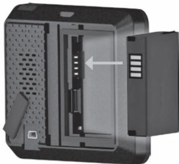
4. Вставьте батарею таким образом, чтобы металлические контакты на батарее были совмещены с металлическими контактами внутри батарейного отсека.
